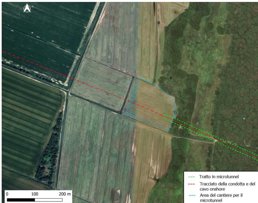
FIGURE 5: LOCALISATION DU POINT D'ATERRAGE ET MICROTUNNEL
